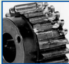
由于弯曲强度不足而造成损坏的一例
